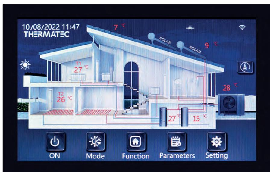
Auf der Hauptoberfläche sind oben von links nach rechts die folgenden Elemente sichtbar: Tag/Monat/Jahr, Uhrzeit, Temperatur, Abtaung, Kaskadenmodus, Quiet-Modus, Wasserpumpe, Rücklaufventil, Elektroheizung, Verdichter, Lüfter, WLAN. Anzeigemodus: Im eingeschalteten Zustand wird der aktuelle Betriebsmodus links von der Hauptoberfläche angezeigt. Im ausgeschalteten Zustand wird kein Betriebsmodus angezeigt.
