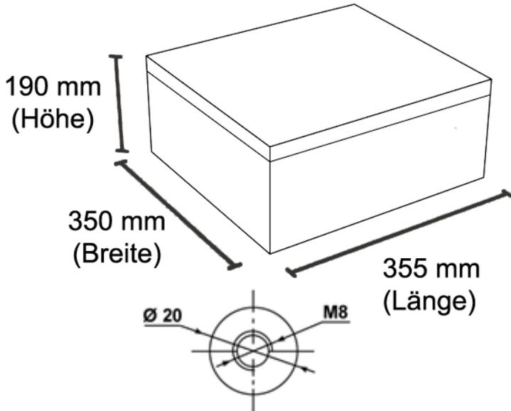
Anschluss: M8 Schraube oder M8 Poladapter
