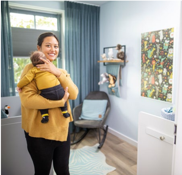
Das Kinderzimmer hat eine Größe von 12 m². Aufgrund der guten Dämmeigenschaft des Raumes wird eine 600 Watt Bildheizung verwendet. Bedruckt wurde die Heizung mit einem Wunschmotiv.
